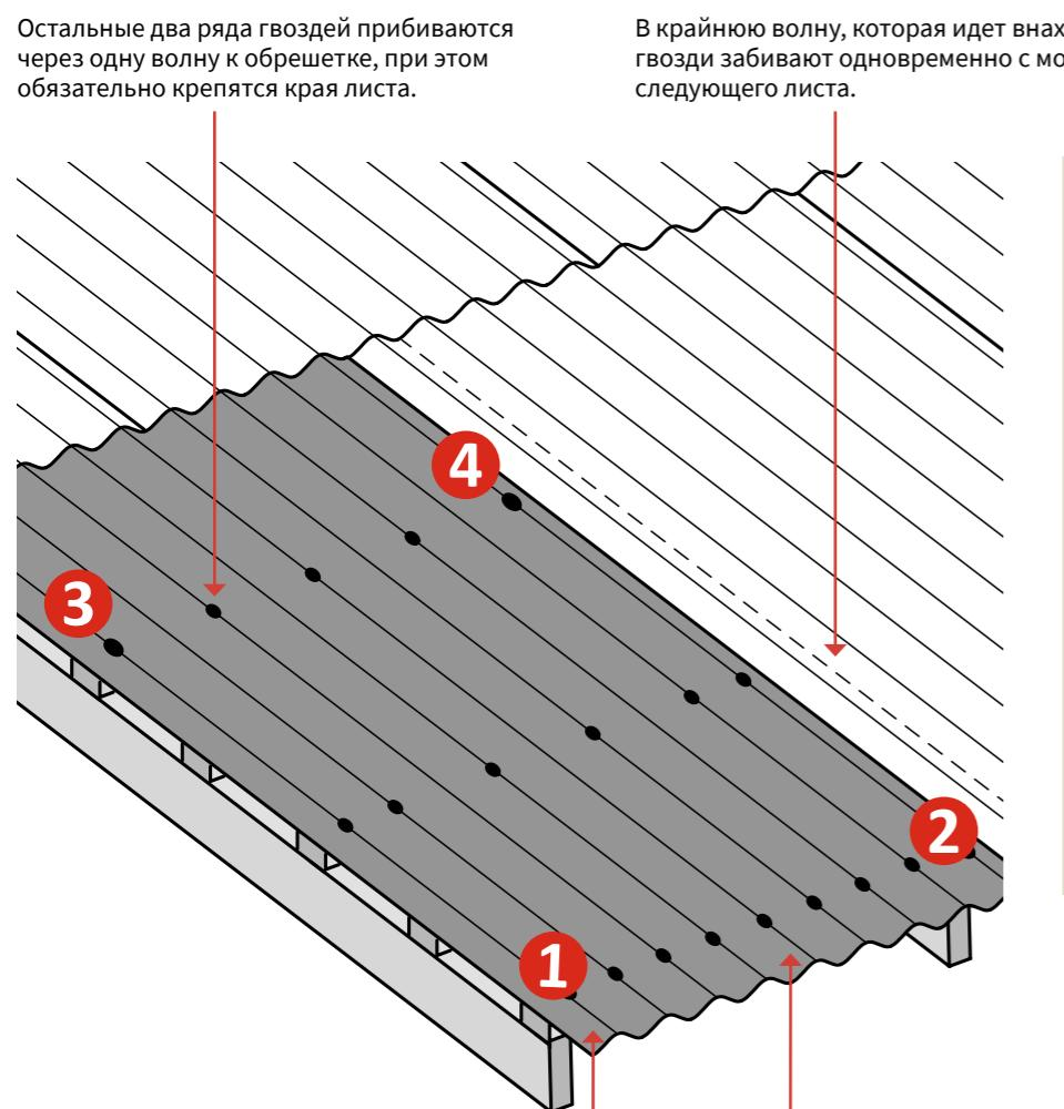
В крайнюю волну, которая идет внахлест, гвозди забивают одновременно с монтажем следующего листа.
