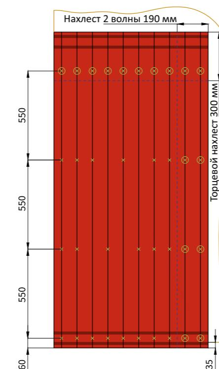
• На данных уклонах, при забивании гвоздей, не следует ориентироваться на разметку, нанесенную на лист! Забивать гвозди следует согласно схеме.
