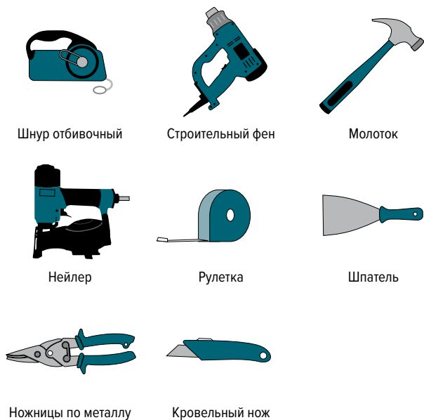
Рис. 1. Необходимые инструменты для монтажа
