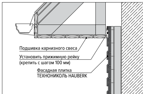
Рис. 9.1. Монтаж верхнего ряда под карнизным свесом
