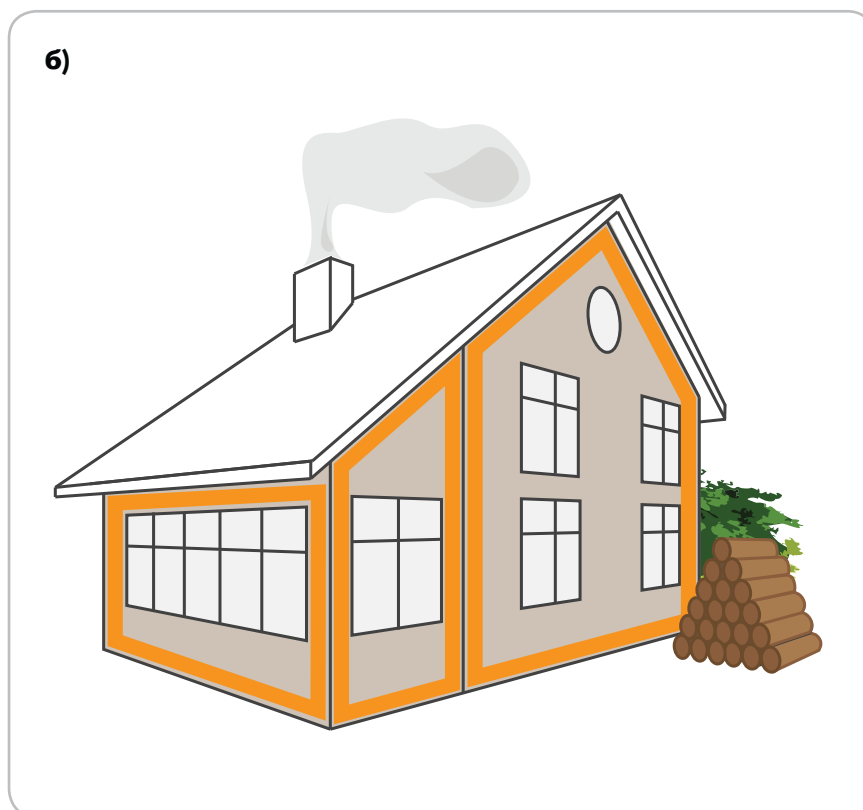
Рис.1.11. Дом а) без утепления, б) с утеплением каменной ватой
