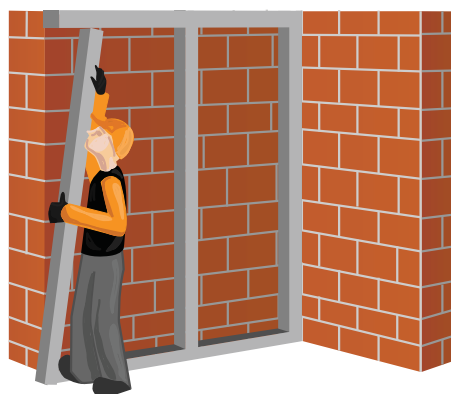
Рис. 6.9. Установка стоечного профиля
