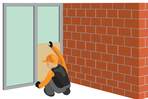
Рис. 6.5. Укладка плит ТЕХНОАКУСТИК
