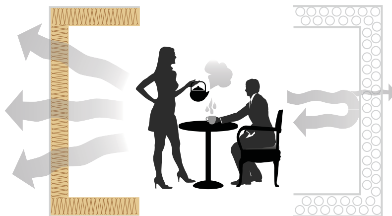
Рис.1.3. Сравнение утепленного каменной ватой и пенопластом помещений.
