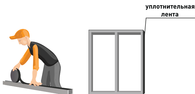
Рис. 6.2. Приклейка и схема расположения уплотнительной ленты в каркасе
