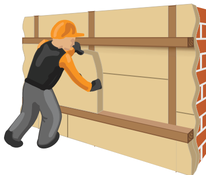
Рис. 7.5. Монтаж теплоизоляционных плит в горизонтальный каркас
