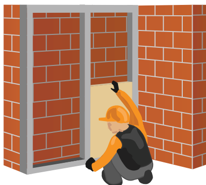
Рис. 6.10. Монтаж теплоизоляционных плит
