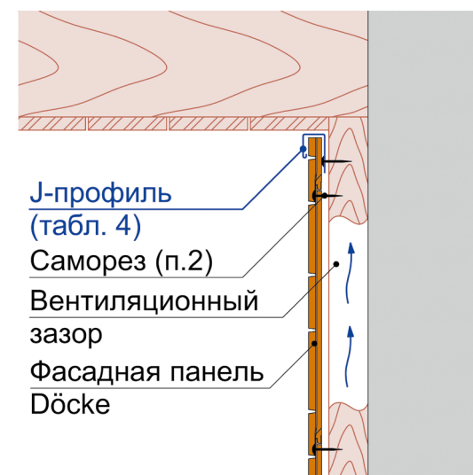
Рис. 26 Примыкание фасадных панелей Döcke к горизонтальной поверхности
