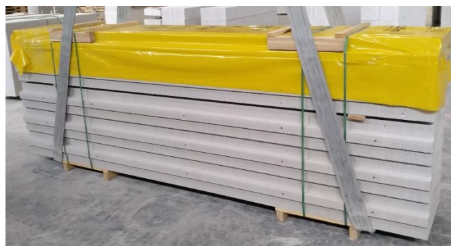
Рис.1 Схема упаковки пачек с панелями перекрытий.
